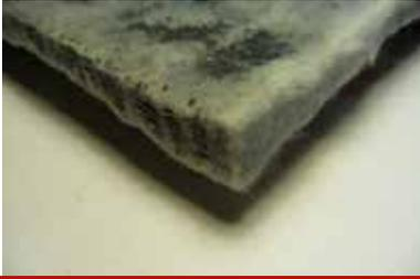
Die flexiblen, nanoporösen Aerogelmatten weisen sehr geringen Wärmeleitfähigkeiten auf. Dadurch können sie platzsparend eingesetzt werden. Zudem können die Matten zur Schalldämmung beitragen.
