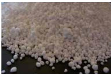
Der Dämmstoff hat neben wärmedämmenden auch schalldämmende Eigenschaften. Es handelt sich hierbei um ein mineralisches Material mit entsprechenden Charakteristika. So ist SLS nicht brennbar und resistent gegenüber Verrottung und Ungeziefer.
