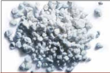
Dämmen mit Vulkangestein – das steht hinter dem Namen Perlite. Er bezeichnet ein bestimmtes Silikatgestein. Als Dämmstoff weiterveredelt entsteht ein Material, das nicht verrottet, nicht brennt und für Insekten unattraktiv ist. Darüber hinaus bietet es gute Eigenschaften in Bezug auf den Schallschutz.
