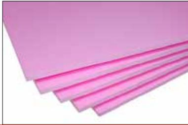
Extrudierter Polystyrol-Hartschaum (XPS) ist ein Dämmstoff für den Härtefall. Im Vergleich zu seinem Verwandten EPS zeichnet sich der zweite Polystyrol-Dämmstoff durch eine höhere Druckstabilität und größere Unempfindlichkeit gegenüber Feuchtigkeit aus. Das Material ist daher eine bevorzugte Wahl, wenn neben einem hohen Dämmwert weitere Anforderungen an den Dämmstoff gestellt werden.
