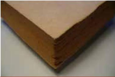
Die Phenolharzplatte zeichnet sich insbesondere durch ihre niedrige Wärmeleitfähigkeit aus. Die wärmedämmende Wirkung ist abhängig von der Dämmstärke, die besten Werte können bei einer Plattenstärke ab 50 mm erreicht werden. Durch die geringe Wärmeleitfähigkeit sind die Platten vor allem für die Anwendungen geeignet, bei denen platzsparend gedämmt werden muss.
