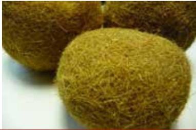
Die Neptunballfasern können zur Wärme- und Schalldämmung beitragen und einen Beitrag zum sommerlichen Wärmeschutz leisten. Wie auch viele andere ökologische Dämmstoffe hat das Material zudem die Fähigkeit, Feuchtigkeit aufzunehmen und wieder abzugeben und somit das Raumklima zu verbessern. Es wird als verrottungs- und ungeziefer sicher deklariert.
