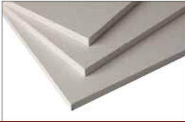
Kalziumsilikat kann Feuchtigkeit puffern, das heißt, einlagern und auch wieder abgeben. Werden die Dämmplatten als Innendämmung eingesetzt, ist aufgrund dieser Fähigkeit der Einbau einer Dampfsperre oder Dampfbremse überflüssig. Als mineralischer Dämmstoff kann Kalziumsilikat nicht brennen und wird daher auch hohen Anforderungen beim Brandschutz gerecht.
