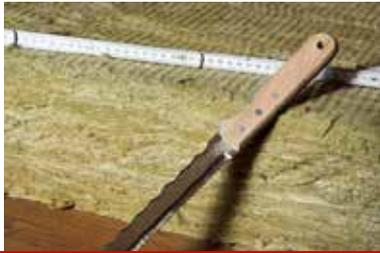
Ein Stein dämmt nicht – Steinwolle jedoch schon. Das liegt an der neuen Struktur, die dem natürlichen Material während der Herstellung verliehen wird. Steinwolle ist ein Dämmstoff, der gemeinsam mit Glaswolle unter dem Oberbegriff Mineralwolle zusammengefasst wird. Die Fasern der Steinwolle bilden ein Vlies, das mithilfe der eingeschlossenen Luft dämmt.
