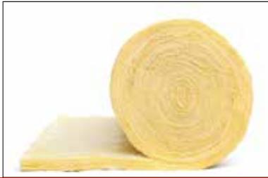
Glaswolle ist einer von zwei mineralischen Faserdämmstoffen, die unter dem Oberbegriff Mineralwolle zusammengefasst werden. Im Grunde handelt es sich dabei um Glas, das durch ein spezielles Herstellungsverfahren in eine andere Form gebracht wird. Das Gewebe aus mineralischen Fasern hält Luft im ruhenden Zustand gefangen, so entsteht eine dämmende Wirkung.
