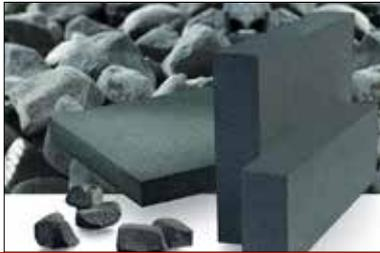
Wer sich immer schon gefragt hat, was mit dem Altglas aus dem Flaschencontainern geschieht: Zum Teil werden sie zur Herstellung eines besonderen Dämmstoffs genutzt – Schaumglas. Dieses Material zeichnet sich durch sehr hohe Unempfindlichkeit gegenüber Feuchtigkeit aus und kann daher auch im Erdreich eingesetzt werden.
